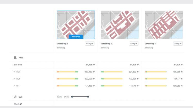
Die Besonderheit ist, dass Spacemaker künstliche Intelligenz und generativem Design nutzt, um Entwürfe auf Basis von 3D-Modellen zu erstellen, analysieren und zu überprüfen – und das in kürzester Zeit. Spacemaker bietet hier sehr viele mögliche Varianten an und vergleicht diese. So schließen Sie den Kreislauf zwischen Design und Simulation. Dies hilft dem Anwender um am Ende die für die vorgegebenen Ziele bestmögliche Variante zu erstellen.
